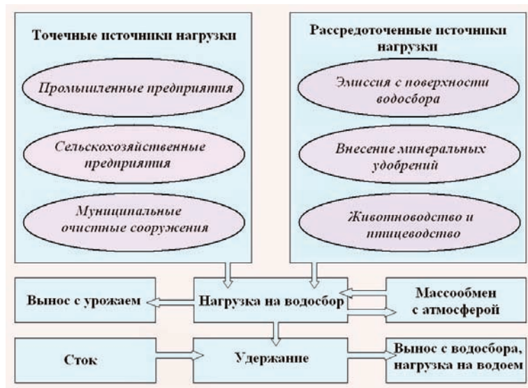
Рис. 2. Схема модели выноса химических веществ с водосбора и формирования внешней нагрузки на водоемы.
